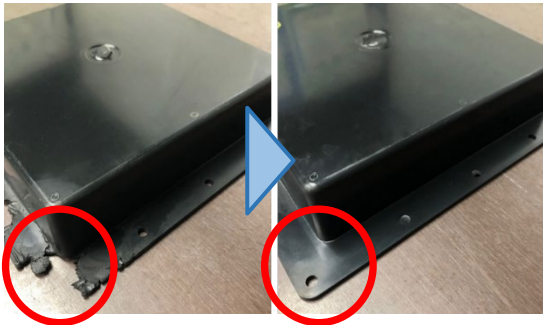
(a) 射出成形 (b) 射出圧縮成形
