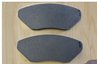
上：リグニン変性フェノール樹脂成型品 下：一般的なフェノール樹脂成型品
