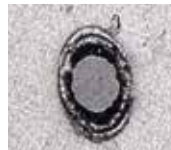
顕微鏡による微孔(ミクロの穴)の拡大写真
