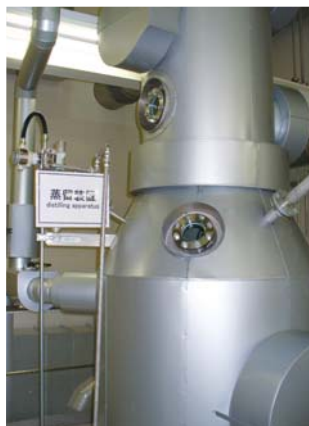
廃イソプロピルアルコールの蒸留回収装置
