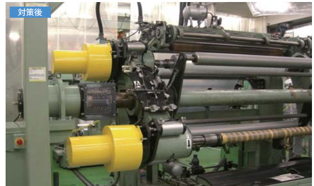
機械への巻き込まれ防止対策（尼崎工場）
