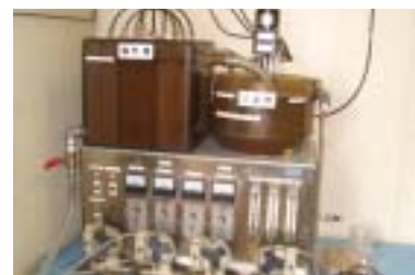
工場排水の微生物処理実験
