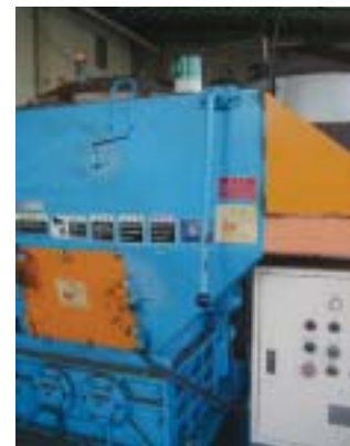
金具/廃プラ分離回収 粉碎機
